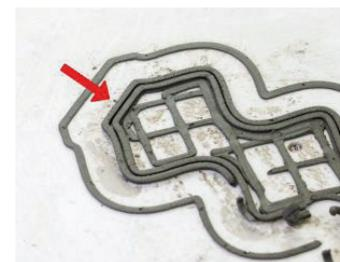
La céramique ne chauffe pas lors de l'impression, les températures restent à 0.
