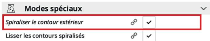
La spiralisation activée permet d'imprimer l'objet en «spirale», donc sans interruption de bas en haut. L'objet est donc imprimé plus rapidement, sans défauts mais d'une seule paroi.
