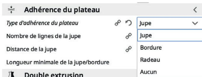
L'adhérence au plateau correspond à la petite bordure que l'on voit à la base des impressions. Une jupe est plus adaptée à la céramique, la bordure créant trop de tension sur le fond, il peut le fissurer au séchage.
