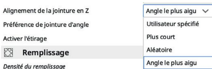
Si vous décidez de désactiver la spiralisation, vous pourrez choisir dans l'onglet «coque» le style de jointure de la pièce. Quand la buse démarre au même endroit dans les couches, il peut apparaître une «couture» verticale sur la pièce. Lorsque la buse démarre de manière aléatoire, les imprécisions de départ de couche seront moins visibles.
